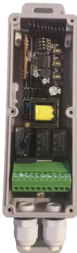
Central para motor tubular con alimentación a 110 – 240 V. Con función OPEN/STOP/CLOSE disponible tanto para interruptor de AC como para los mandos compatibles a 433.92 MHz.
