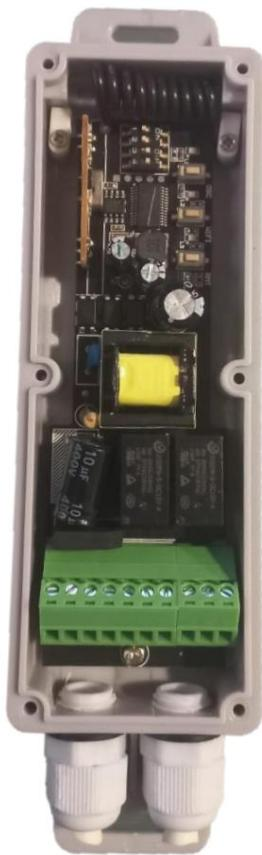
Centrale di comando per motore tubolare con alimentazione 110 – 240 V. Con funzione OPEN/STOP/CLOSE disponibile sia per interruttore AC che per comandi compatibili 433,92 MHz.
