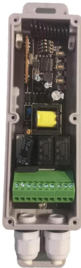
Centrale de commande pour moteur tubulaire avec alimentation 110 – 240 V. Avec fonction OPEN/STOP/CLOSE disponible aussi bien pour interrupteur AC que pour commandes compatibles 433,92 MHz.
